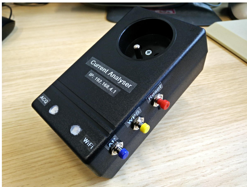
Obrázek 6.10: Vnější podoba měřicího přístroje; v dolní části panelu dvě barevné indikační LED
