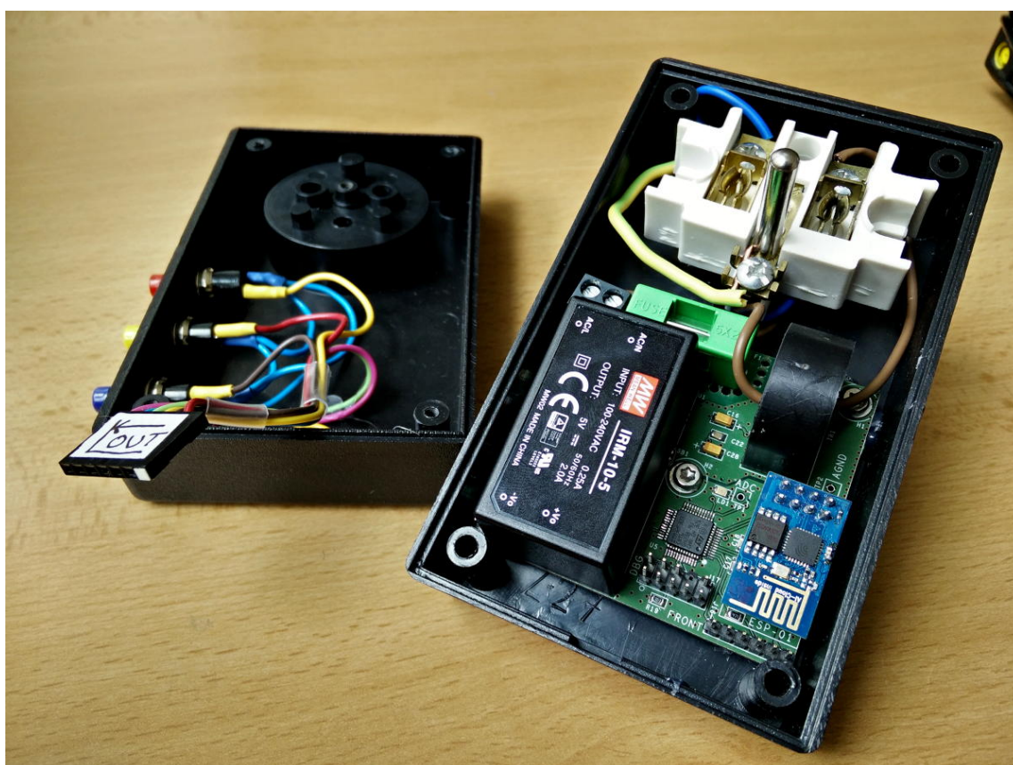
Obrázek 4.7: Fyzické uložení desky plošných spojů v adaptérové krabičce; vlevo: odpojený přední panel
